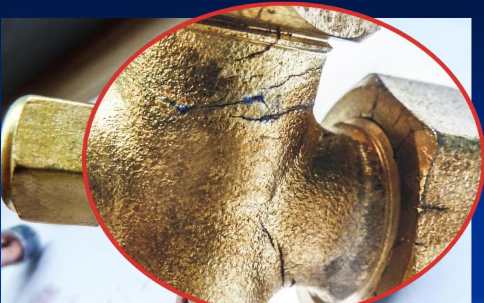
因为存在残余拉应力，经氨熏试验，发生严重的裂纹。这是典型的应力腐蚀现象。
