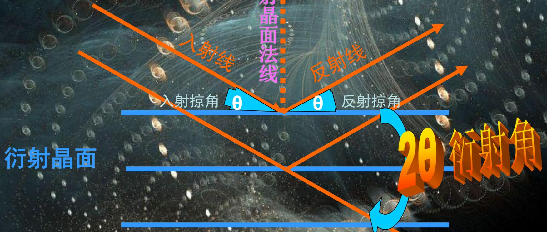
$\theta$  角是入射线、反射线与晶面的夹角，因为晶面是微观的，所以  $\theta$  角不可观察。但是  $2\theta$  角却是容易观察到的，它就是入射线延长线与反射线之夹角。
