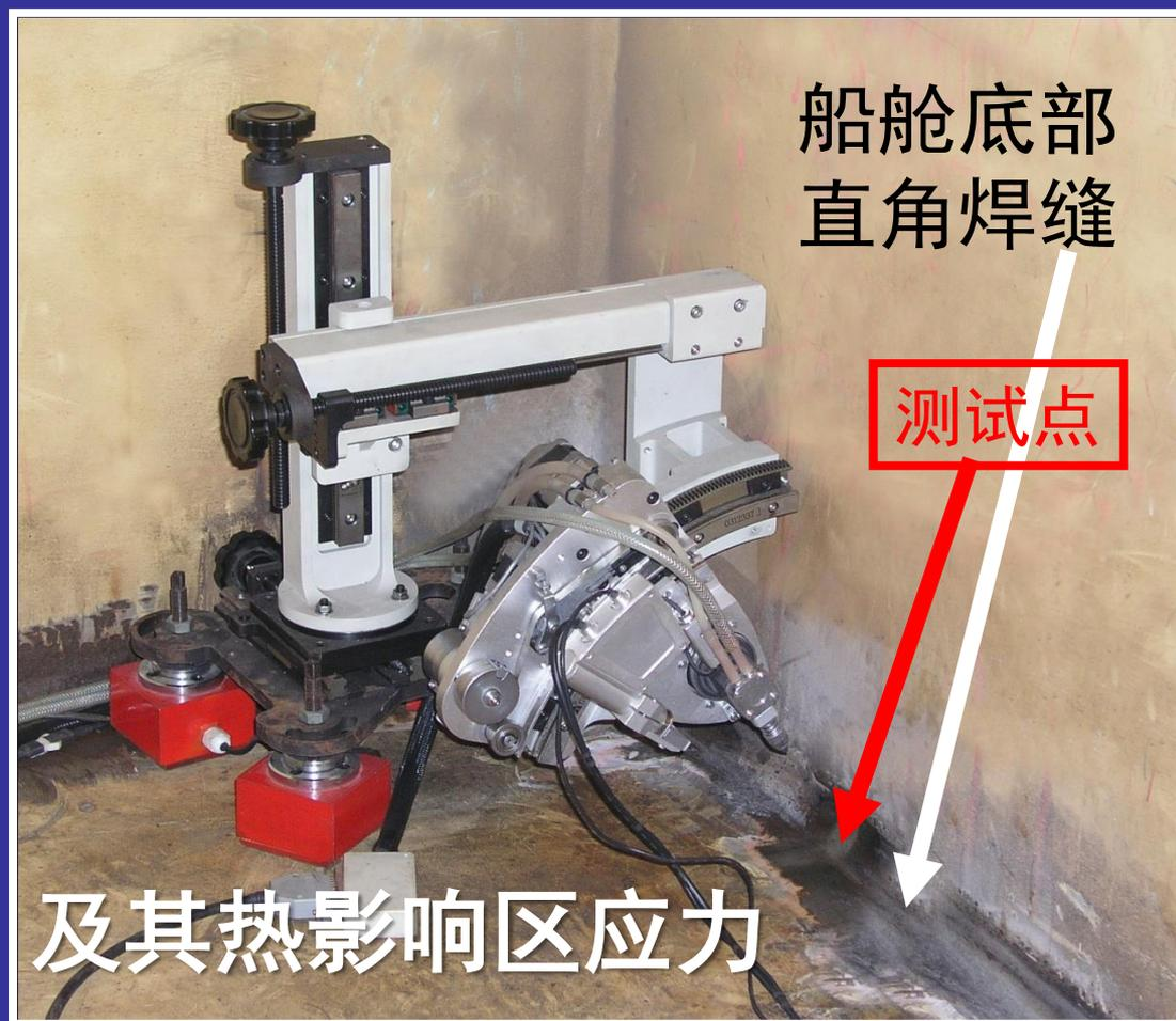
测定直角焊缝
