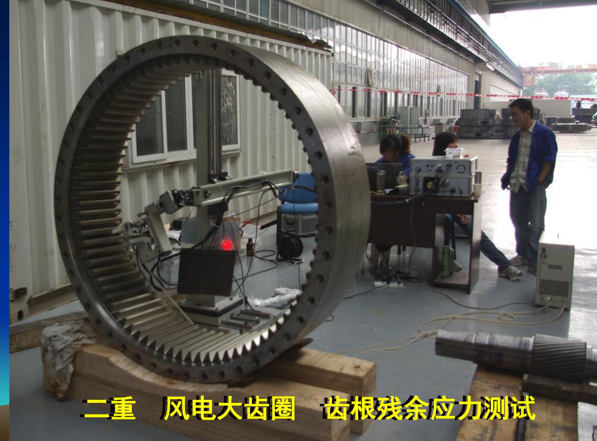
**二重 风电大齿圈 齿根残余应力测试**
