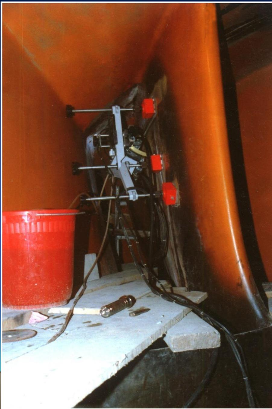
1998年我们携带X射线应力仪到二滩水电站，测定转轮现场焊缝的残余应力。
