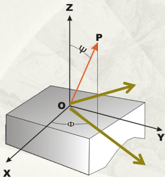
至此，我们得到了试样表面指定点（o）指定方向（平径角 $\Phi$ 所确定的方向）的应力。
