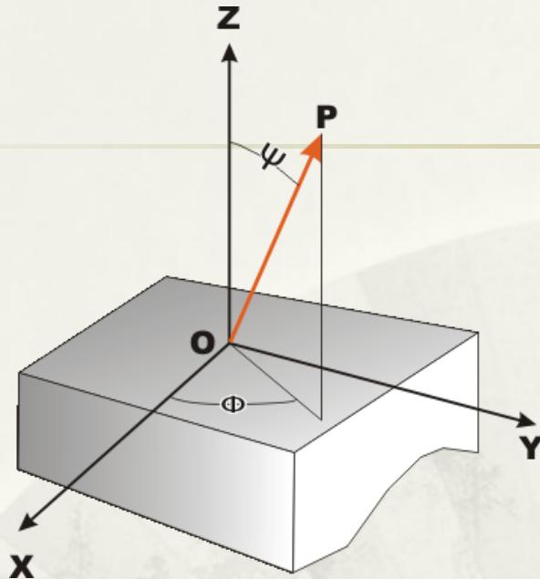
根据广义胡克定律，可推导出OP方向的宏观应变  $\varepsilon_{\Phi\psi}$  与各应力分量及  $\Phi$  角  $\Psi$  角的关系：
